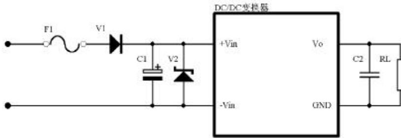
本系列产品都有内置的滤波器，能满足一般电源应用的要求。输入端 C1 为电解电容以吸收模块输入端的电压尖峰并为模块提供一定的维持电压，V2 为瞬态吸收二极管配合保险丝 F1 使用，可防止输入电源瞬态高压将损坏电源模块，确保模块在安全的输入电压范围内。V1 为反接保护二极管。瞬态吸收二极管 V2 选型参见推荐表。C2 为独石或薄膜电容。PCB 板布线时，输入，输出铜线应尽可能宽，且线间距不宜过大，输出开联电容应尽可能与模块电源靠近，以降低干扰。
